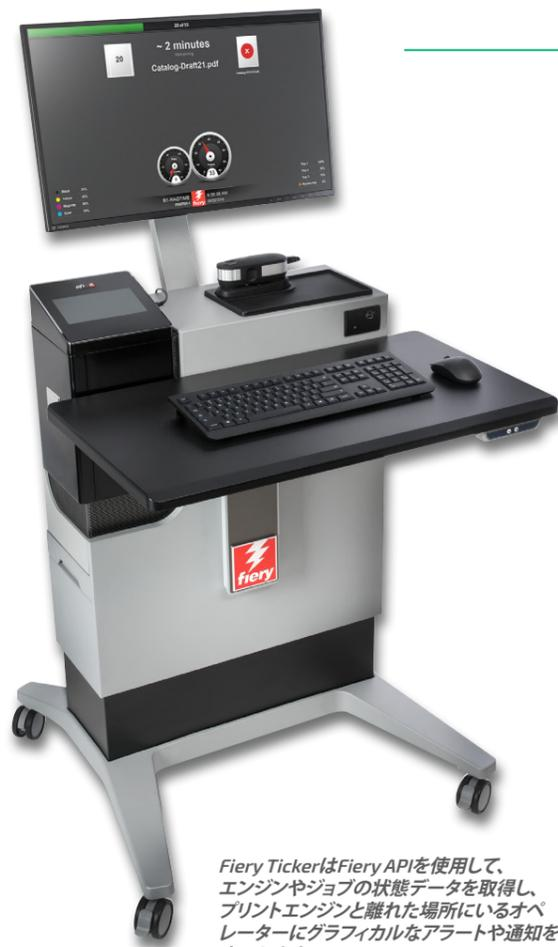
Fiery TickerはFiery APIを使用して、エンジンやジョブの状態データを取得し、プリントエンジンと離れた場所にいるオペレーターにグラフィカルなアラートや通知を表示します。
