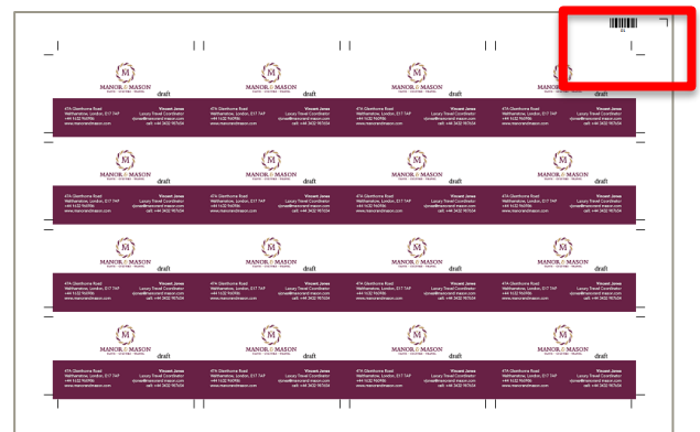
Automatisierung von der Vorstufe bis zur Weiterverarbeitung dank Finisher-spezifischer Registrierungsmarken und Barcodes
