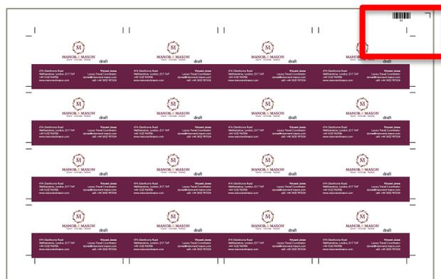
*Applicazione di crocini di registro e codici a barre specifici per l'unità di finitura per automatizzare il processo dalla pre stampa alla finitura*
