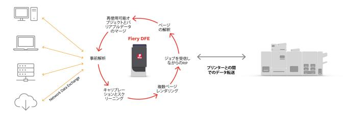
多段階の並列処理によって Fiery DFE のスケールアップが可能となり、印刷エンジンの印刷回数は、A4/レターで毎分 2,400 回にも達します。このドキュメントの執筆時点で、Fiery DFE は 2 メートル超の印刷エンジンに統合され、解像度 1200 x 1200 dpi 以上、8 色または 12 色のインクで印刷速度は毎分200 メートルを超えます。
