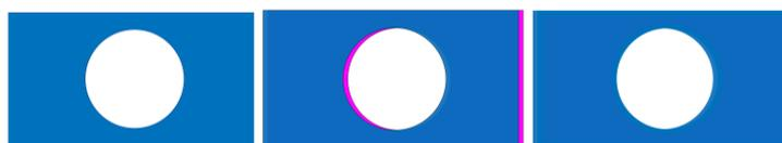
正常な出力の例（調整に成功）      位置ずれのある出力の例      カットバックトラッピングによって、最も濃いものを除くすべてのインク/トナーが引き出
