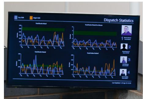
Les informations en temps réel sur le statut de la production collectées à l'aide de Fieri API sont utilisées pour calculer et mettre à jour en permanence des chiffres et des graphiques importants relatifs à la production et les présenter sur de grands écrans dans l'atelier de production pour que chacun puisse visualiser instantanément l'ensemble des tâches et accroître l'efficacité.
