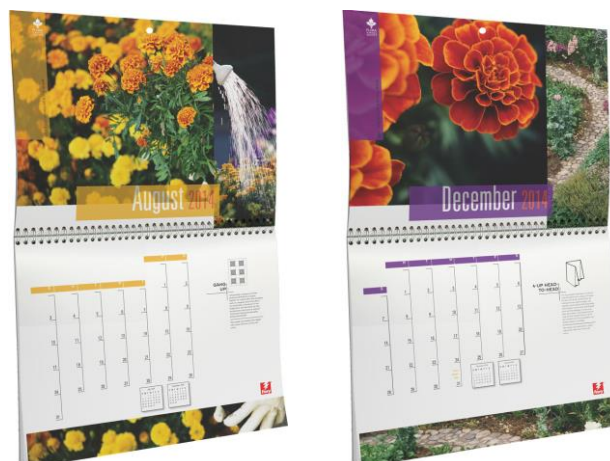
Kalendáře využívající vyřazování typu opakování společného tisku a horní okraj pro vazbu
